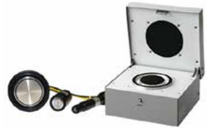
Messbox für Messungen nach JIS K 6911-1995
